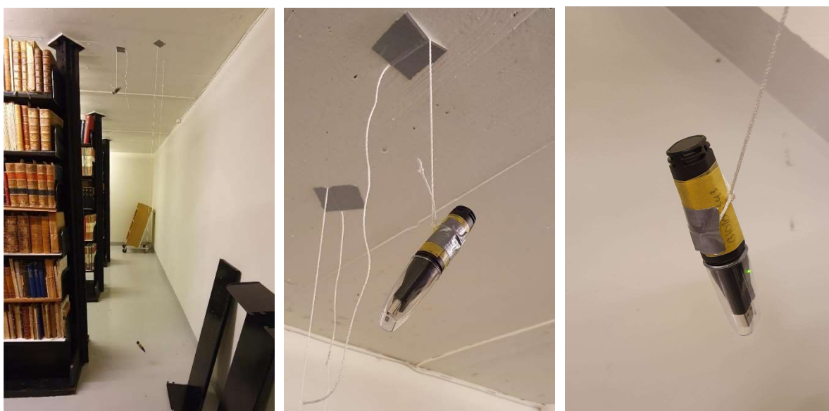
Figur 3.1: Metode for opphenging av loggerne
