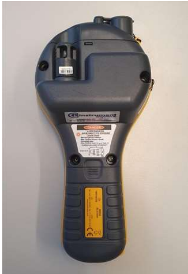
Figur 3.3: Sensoren er plassert øverst til venstre
