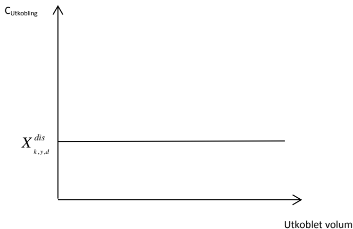
Figur 26 kostnadsfunksjon til av/på reduksjon med variabler
