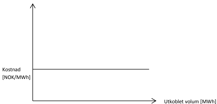
Figur 18 kostnadsfunksjon til av/på reduksjon
