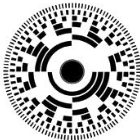
Figur 21.5: Disken til en rotasjonskoder. Hver posisjon tilsvarer en kode på disken. (electronics-tutorials 2014)
