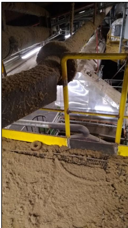
Figur B.3: Tegn på tidligere luftlekkasje
