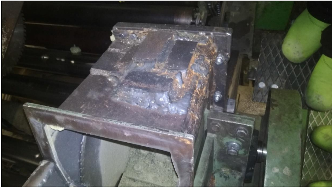
Figur B.4: Tilstand sneglehus på sag
