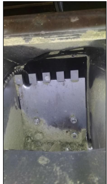
Figur B.4: Slitasje i sag
