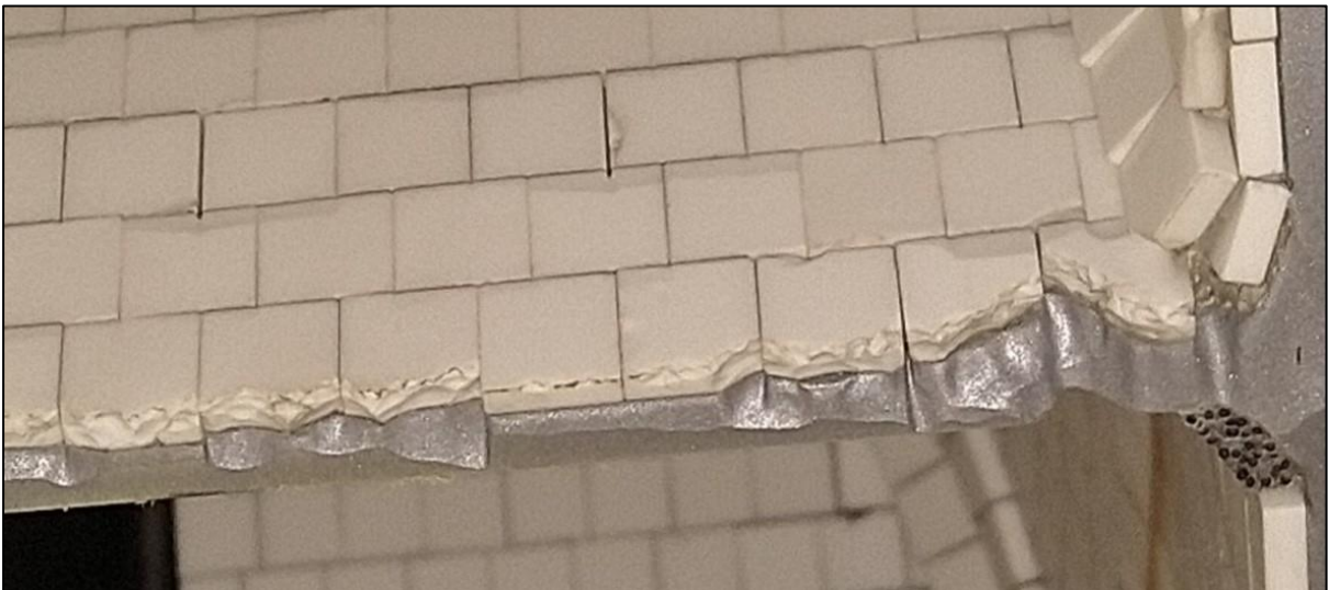
Figur B.12: Sår på impeller til syklovifte
