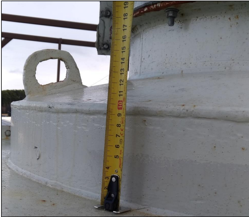
Figur 4.20: Skrå del på topp av syklonkropp
