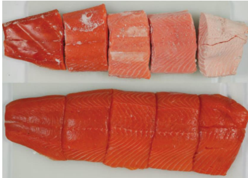
Figur 2.8. Øverste bildet viser laks innfrost ved forskjellige temperaturer (fra venstre -15,-20,-40,-80 °C og flytende nitrogen), nedre del viser laksen etter tining (Ottestad m.fl. 2011, s. 426).
