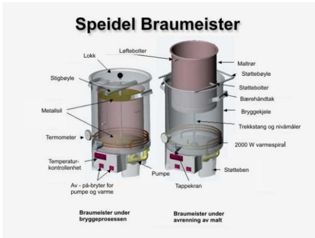
Figur 7 - Oppbygning av Speidel Braumeister med navn på komponenter (Kristianiabrygg 2011 s. 4)
