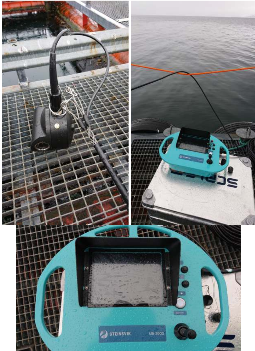
Figur 12: Kamerautstyret som ble anvendt til å lage sei-datasettet (film av sei under vann). Nofima anskaffet et undervannskamera av typen Steinsvik Orbit-3300 som styres via et MB-3000 kontrollpanel. Foto: Nofima (Lindberg og Evensen 2020).
