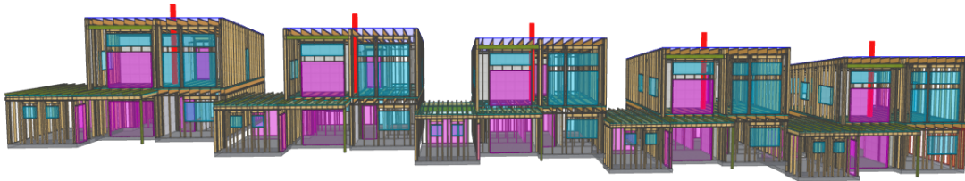
Figur 3.6: Jatak Are Brugs BIM-modell av bindingsverket i eneboligene
