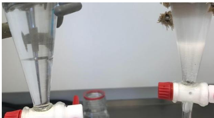
Figur 25: Bilde av emulsjon ved ekstraksjon av sjøvannsprøver. Til venstre: replika (UV1) uten emulsjon. Til høyre: replika (UV2) med emulsjon.
