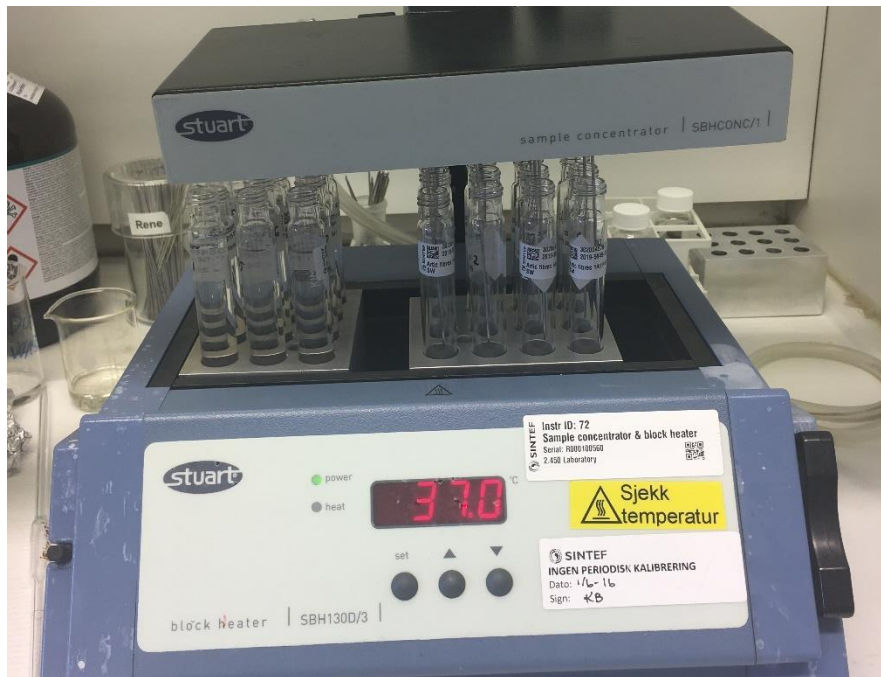
Figur 20: Oppsett for oppkonsentrering av ekstrakt
