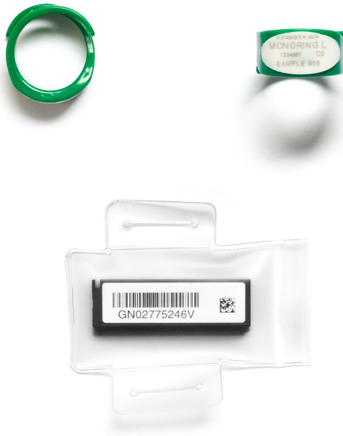
Figur 2: Øverst er ringdosimeteret “Monoring” avbildet fra to hold. Nederst er ekstremitetsdosimeteret avbildet.
