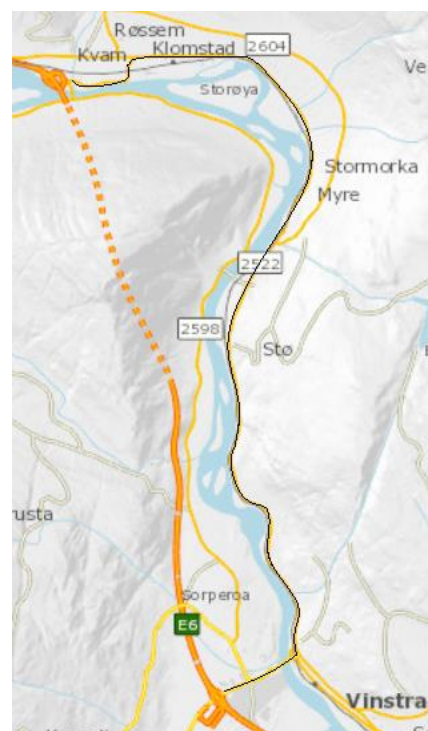
Figur 4.13 - Omkjøringsveg for Teigkamptunnelen.
