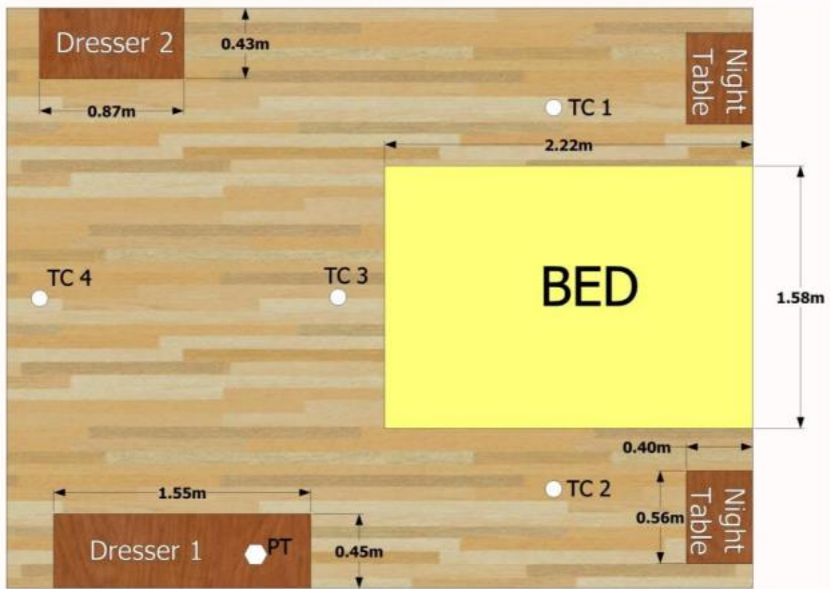
Figur 6 - Illustrasjon av testoppsettet brukt i Medina Hevias brannforsøk. (Medina Hevia, 2014, s.53)
