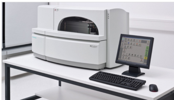
Figur 8: Analyseinstrumentet BN ProSpec som benytter analysemetoden Freelite fra The Binding Site for konsentrasjonsmåling av frie, lette immunglobulinkjeder. (8)
