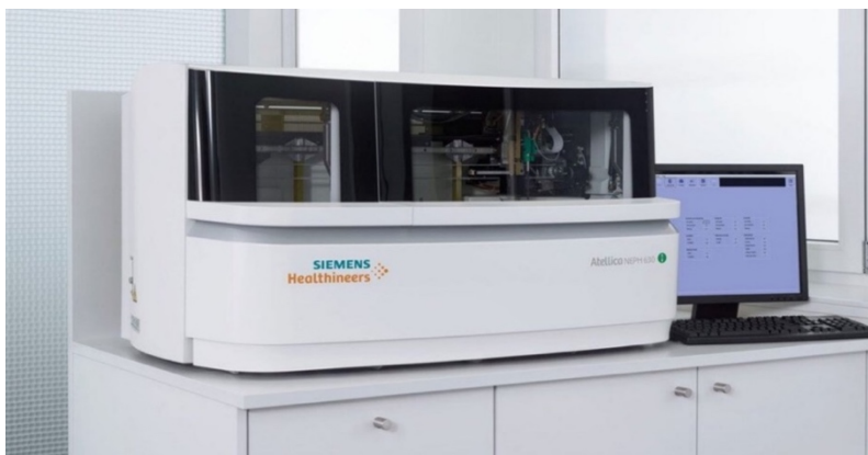
Figur 7: Atellica NEPH 630 brukes til analysering av frie kappa- og lambda-kjeder. (7)
