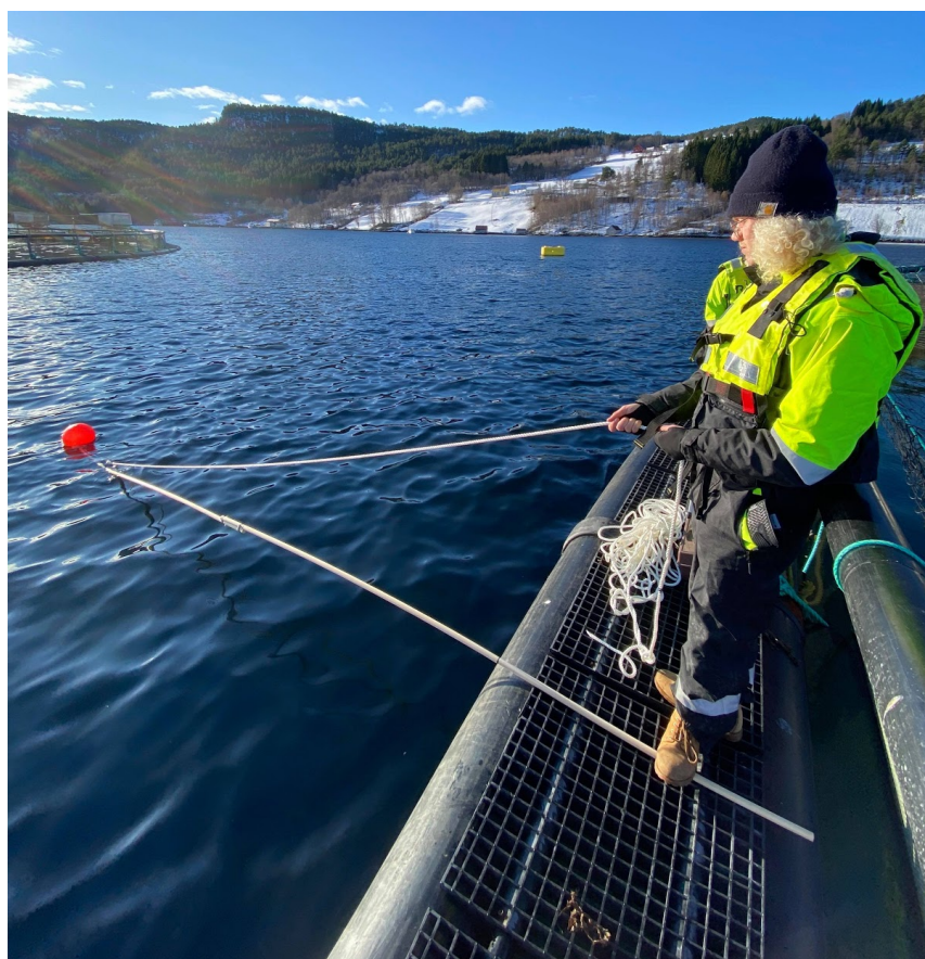
Figur 8. Kamerarigger i bruk. Illustrasjon av kamerariggen i bruk. Her var kamerariggen på 5 meter dybde og klar til å starte tidtakingen på 60 sekunder på klarsignal fra operatørene av to de andre riggene.
