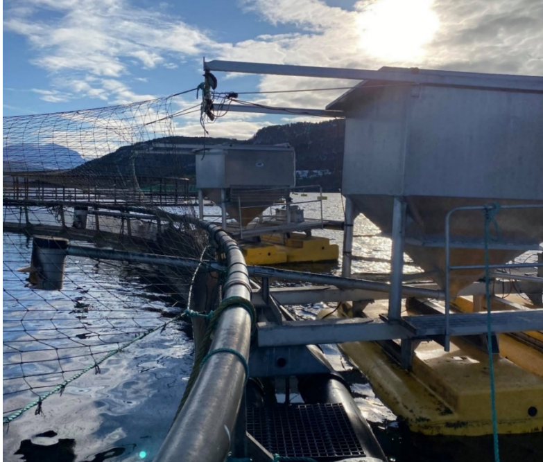
Figur 3. Fôringsautomater. Bildet viser de sidemonterte fôringsautomatene ved Seterenesetet.
