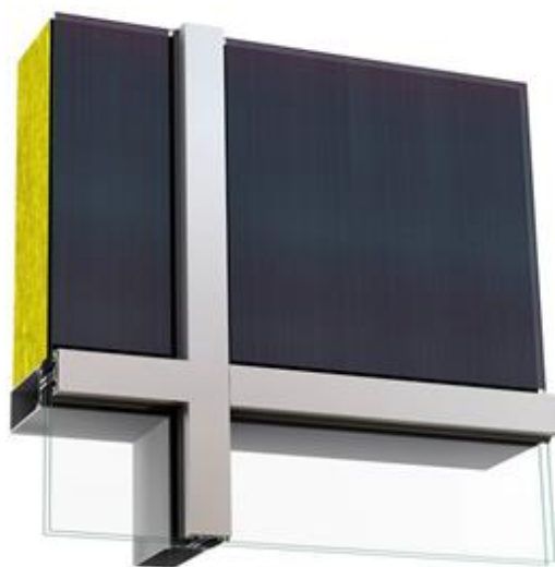
Figur 22 – Oppbygging av monteringsprinsippet ved bruk av fasadeglass.
