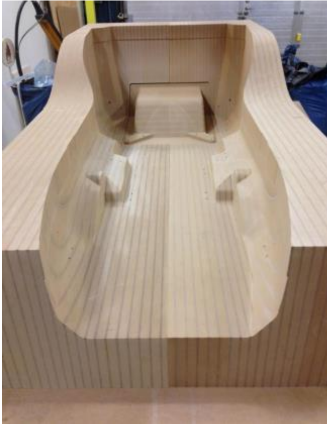
Figur 5.4: Form til Formula Student-monocoque av MDF-plater
