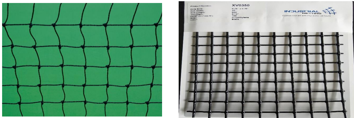
Figur 52: Netting vevd med knuter og netting ekstrudert uten knuter
