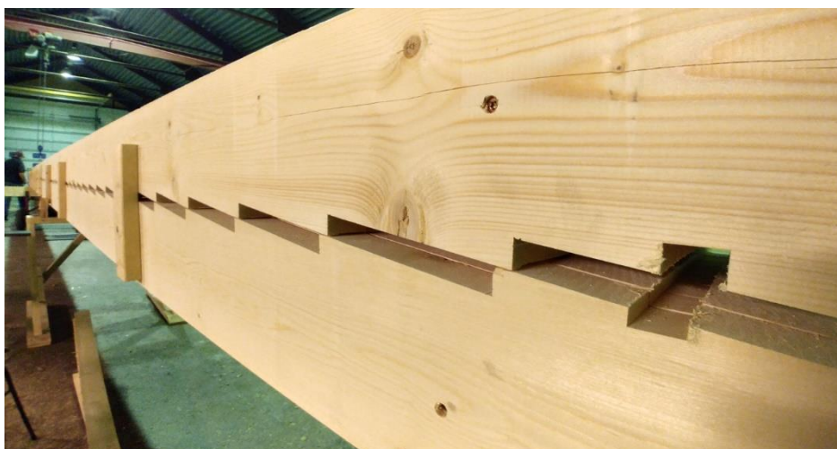
Figur 34: Teknikk for «tannbjelker» (117).
