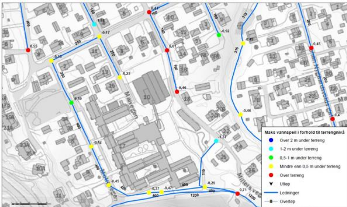
Figur 5.18 Vannspeil i kum etter endrede dimensjoner, Motrøvegen
