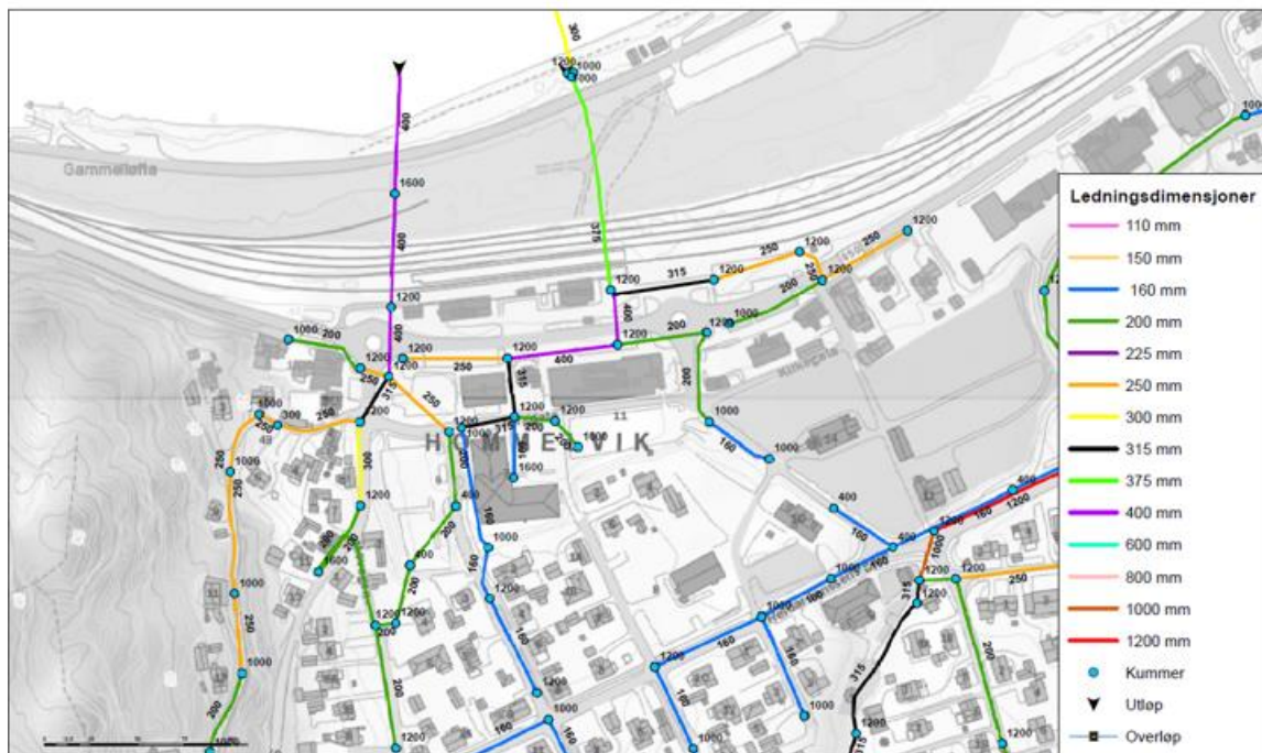
Figur 7.19 Ledningsdimensjoner, endelig løsning, versjon 4
