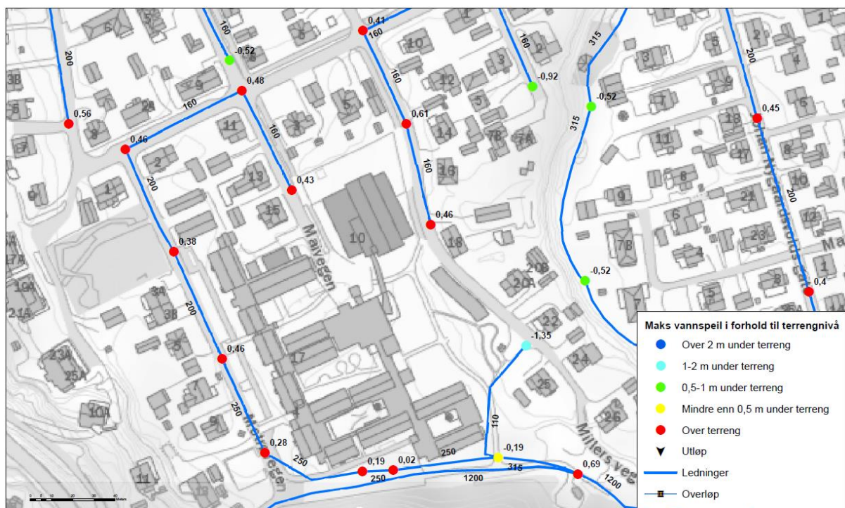
Figur 5.16 Eksisterende vannspeil i kum før endringer, Motrøvegen
