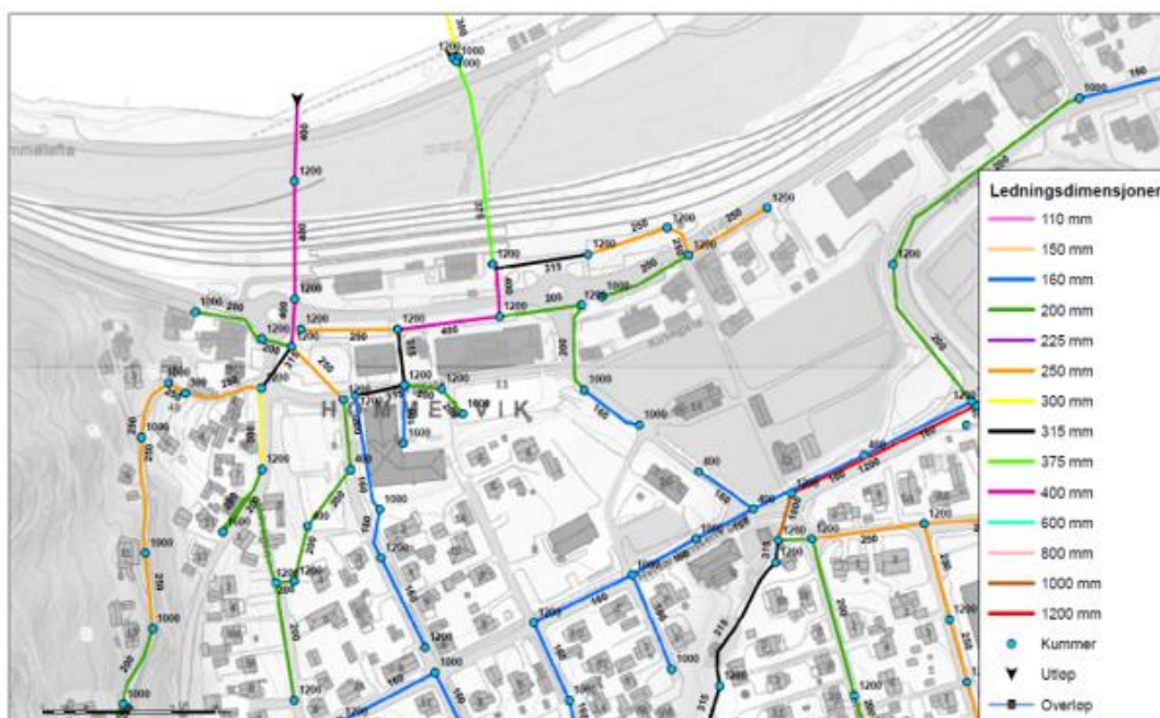
Figur 5.12 Lednings- og kumdimensjoner, ny utløpsledning, versjon 3 (DN400)
