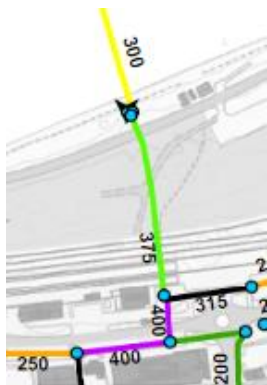
Figur 4.33 Ledningsdimensjon utløp, nett 1
