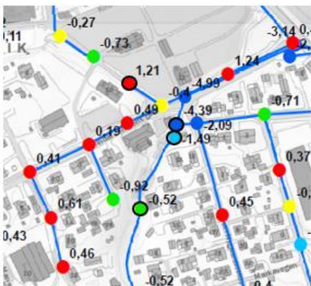
Figur 4.41 Maks vannspeil under terrengnivå med Stjørdalskummer (markert med svart sirkel), Millers veg og Reidar Jenssens gate
