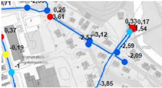
Figur 4.35 Maks vannspeil i forhold til terrengnivå, nett 2
