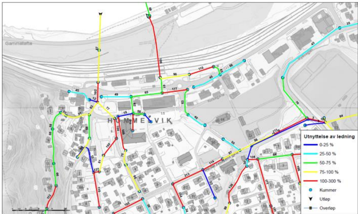
Figur 7.21 Utnyttelse av ledningskapasitet, endelig løsning, versjon 4
