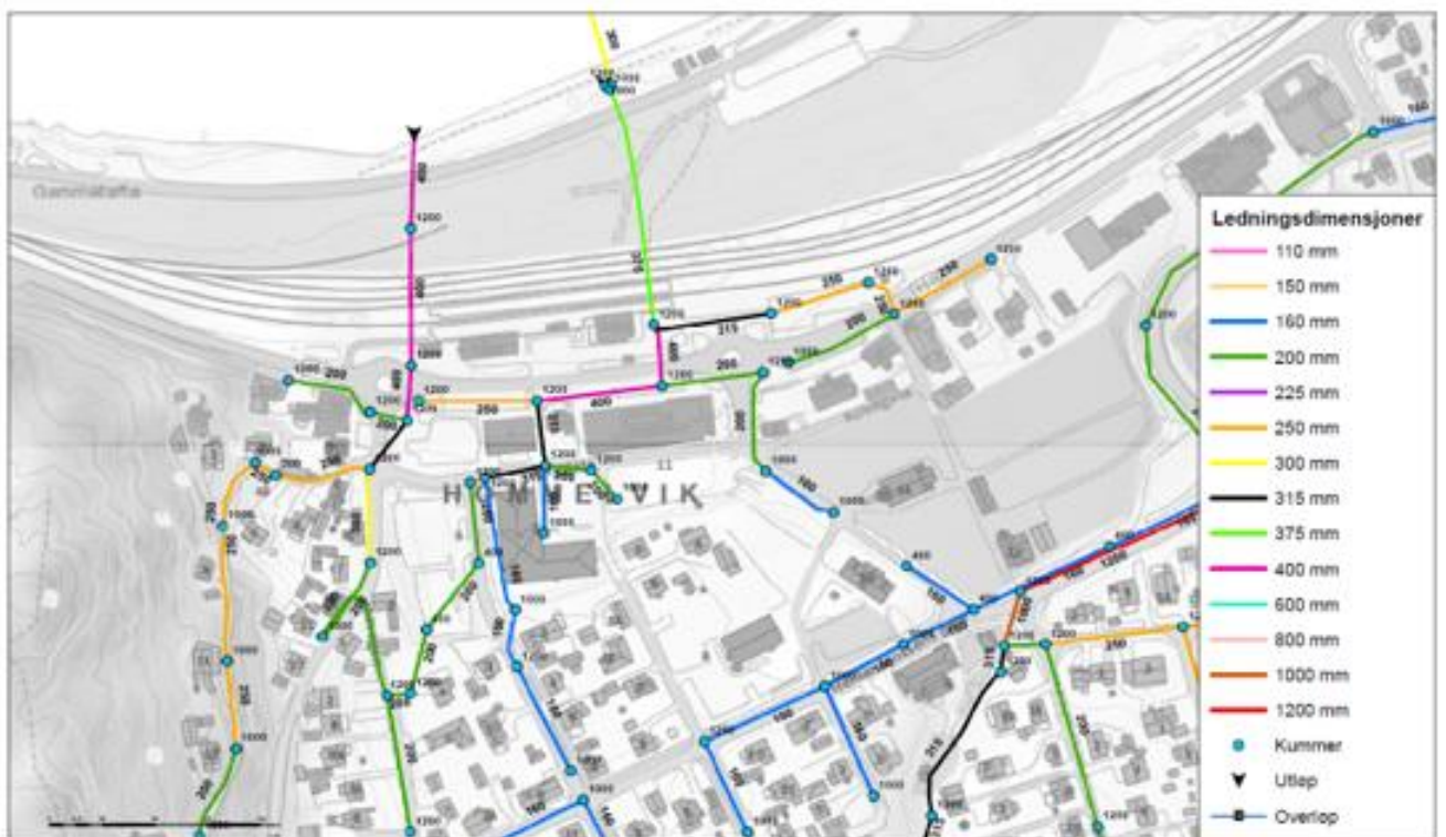
Figur 5.7 Lednings- og kumdimensjoner, ny utløpsledning, versjon 2 (DN400)
