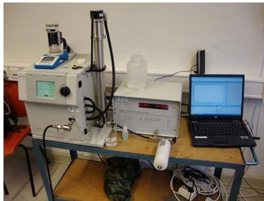
Figur 28: Bilde av TSI-3936 SMPS med TSI-3080 EC, påmontert TSI-3081 LDMA til venstre. TSI-3025 CPC sees i midten. Til høyre sees pcen som ble brukt til å styre målingene. I nedre venstre kant sees den svarte slangen som ble påmontert kokken.
