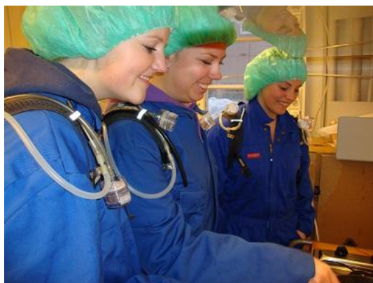
Figur 25: Bilde av testpersoner påmontert måleutstyr. Filterkassett på den nærmeste testpersonen og svart slange til SMPS har glidd noe ned i det bildet ble tatt.
