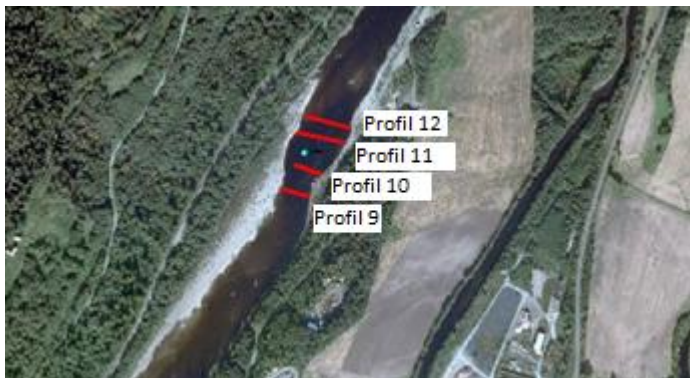
Figur 25. Den dype kulpen oppdaget av Hydra Team ved Lundamo, og tverrprofilene 9-12 målt i denne sammenheng.
