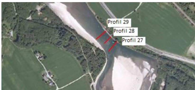
Figur 26. Den dype kulpen oppdaget av Hydra Team ved Øyan, og tverrprofilene 27-29 målt i denne sammenheng.
