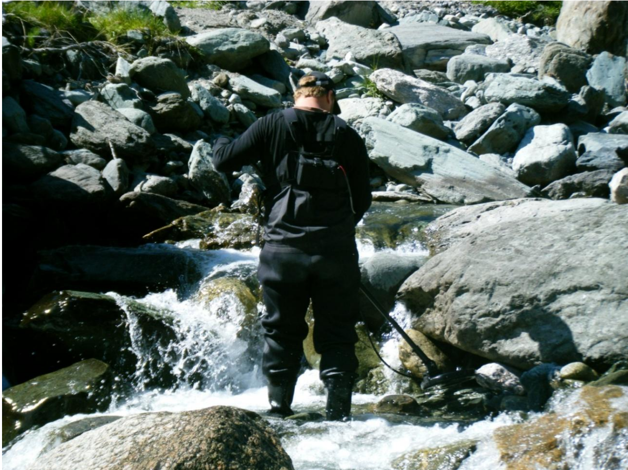
Figur 3.4: Søkning etter passive integrerte transpondersendere i Vekveselva. Utstyr som er påkrevd er vadere, antenne, mottaker og batteri. Foto: Stine Waldum.
