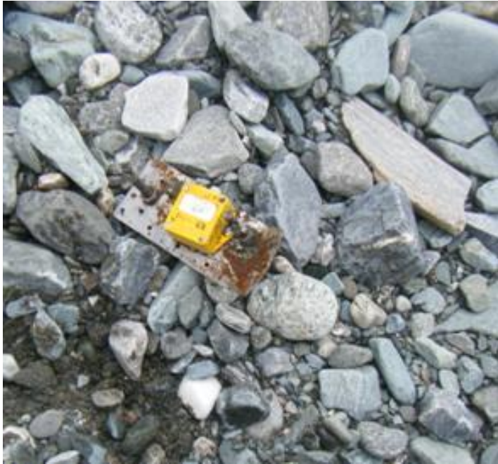
Figur 3.7: Sjokksensor som registrerer maks akselerasjon gjennom et gitt tidsintervall (Foto: Stine Waldum).
