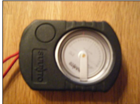
Figur 18: Inklinometeret som ble brukt under feltarbeidet (Foto: Stine Waldum).
