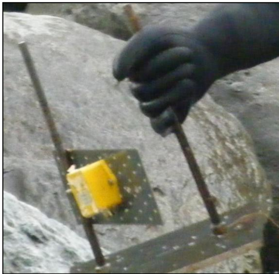
Figur 13: Slik var sjokksensoren montert under feltarbeidet. Den var festet på høyre side også (Foto: Stine Waldum).
