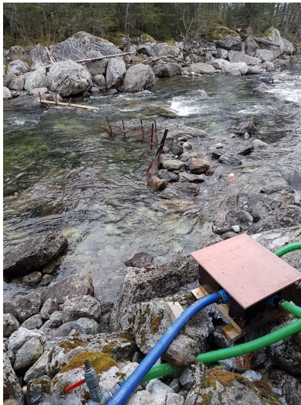
Bilde 3: Tversnittet av utløpselva fra Urvoldvassdraget med ledegjerder. Fire overvåkingskameraer var plassert på bunnen i de to «vandringsrutene» som dannes av ledegjerdene. I forgrunnen er turbinen, som sørger for strømforsyning til videosystemet. Foto: Anders Lamberg.
