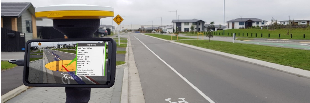
Figur 23 Trimble Sitevisjon - Utvidet virkelighet. Kilde: sitevision.trimble.com .
