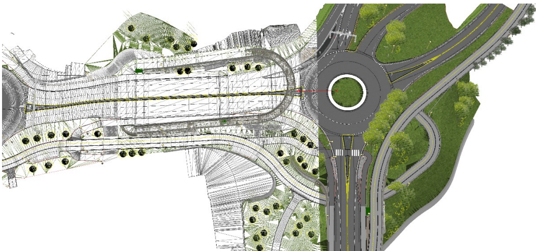
Figur 29 Utklipp fra Tverrfagligmodell i Novapoint. Til venstre ses modellen fra et teknisk perspektiv og til høyre fra et visuelt perspektiv. Kilde: (E18 Rona/Statens vegvesen 2019)
