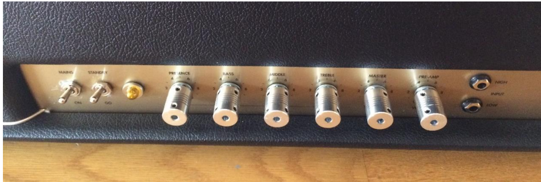
Figur 2.10: Frontpanel på forsterkeren med fleksible mellomkoblinger for tilkobling av stepper motorer.
