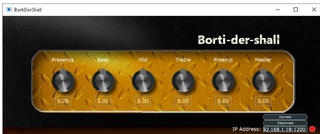
Figur 2.2: Grafisk brukergrensesnitt til fjernstyringssystem. Virtuelle ratt langs rad på midten. Nettverksfunksjonalitet er plassert nederst i høyre hjørne.
