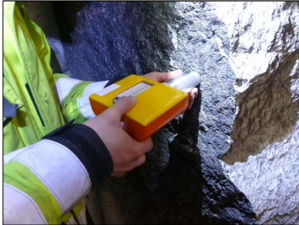
Figur 43 Test med Schmidthammer på en frisk bergflate i tunnelen. Bildet er hentet fra Måling 1.
