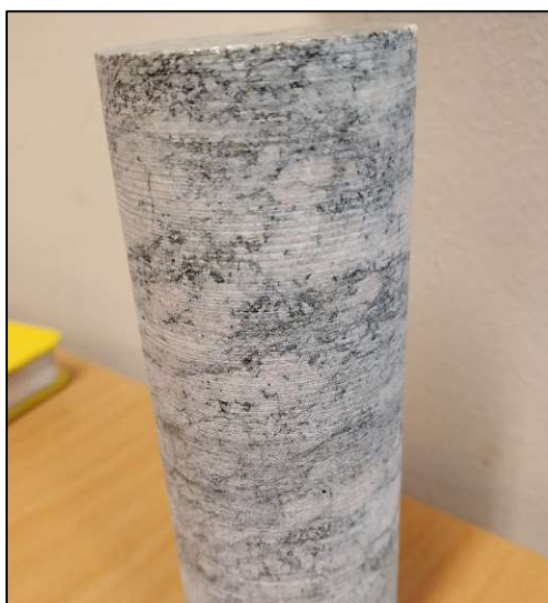
Figur 49 Riller dannet langs prøvestykket fra boring.
