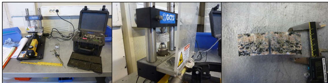
Figur 47 Oppsett for punktlasttest med GCTS mobil punktlastpresse, midtste bilde viser prøvestykke plassert inne i maskinen før en aksial test. Siste bilde viser oppmåling av lengden mellom bruddpunktene(D).
