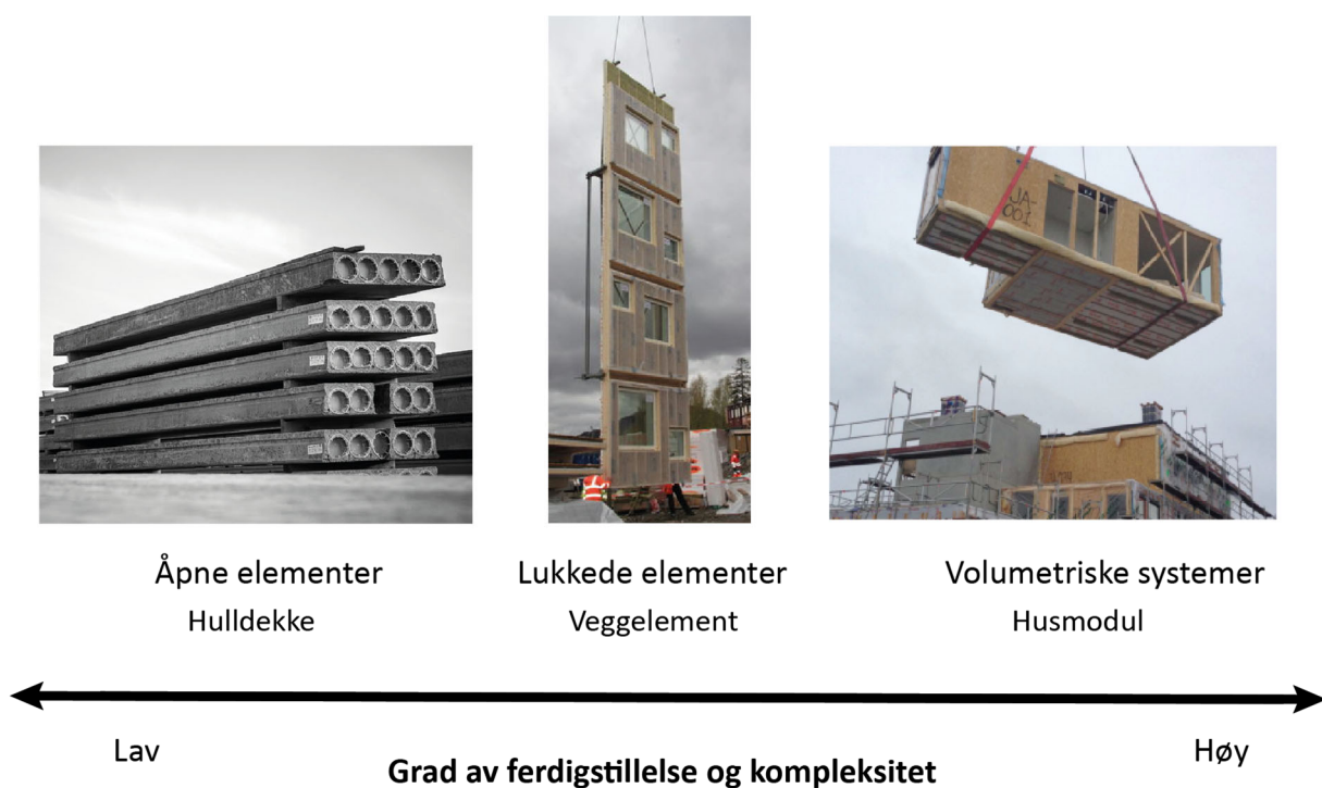
Figur 1 Variasjoner av prefabrikkering. Viser eksempel for hver kategori. Opphavsrett for bilder fra venstre: Nor Element (2017), Byggeindustrien (2014), Haugen (2015)
