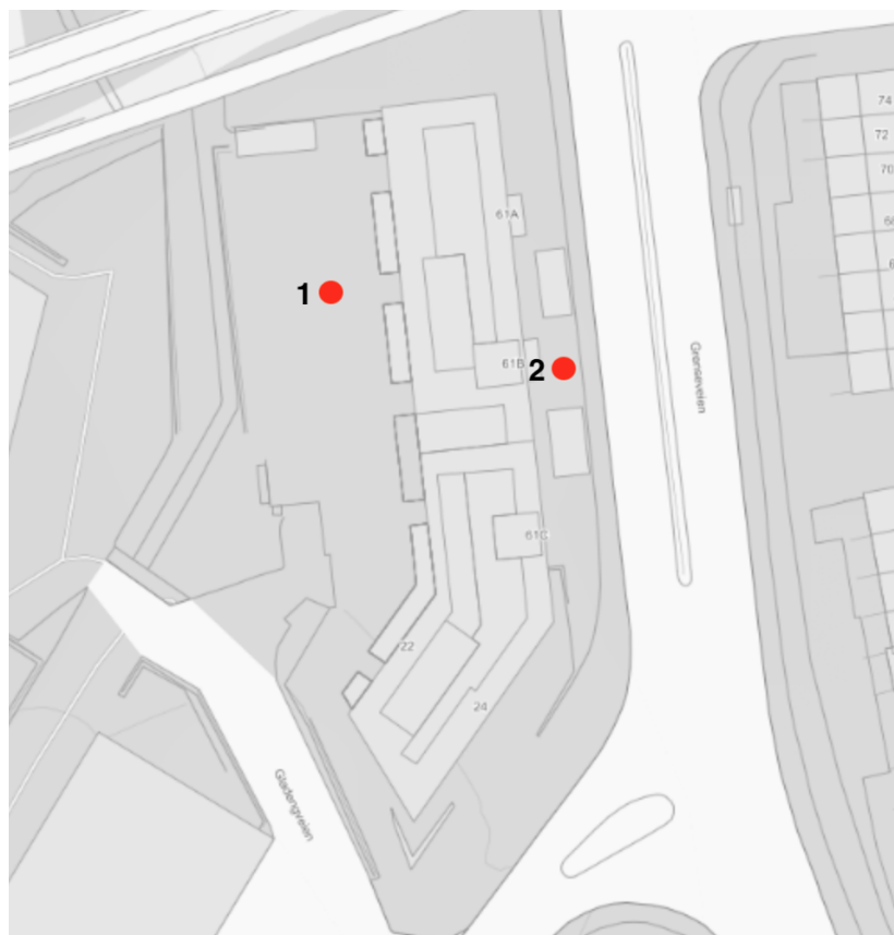
Figur 5.12: Målepunkter for feltmålinger For kontroll ved Hovinbekken III. Punkt 1 viser målepunkt på stille side og punkt 2 viser målepunkt på trafikksiden.
