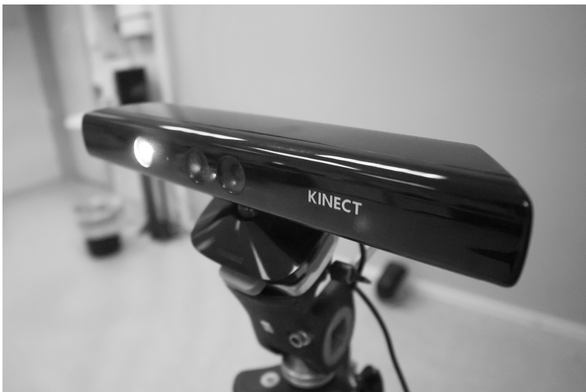
Figur 42: IR-foto av Kinect med IR-laser aktivert.
