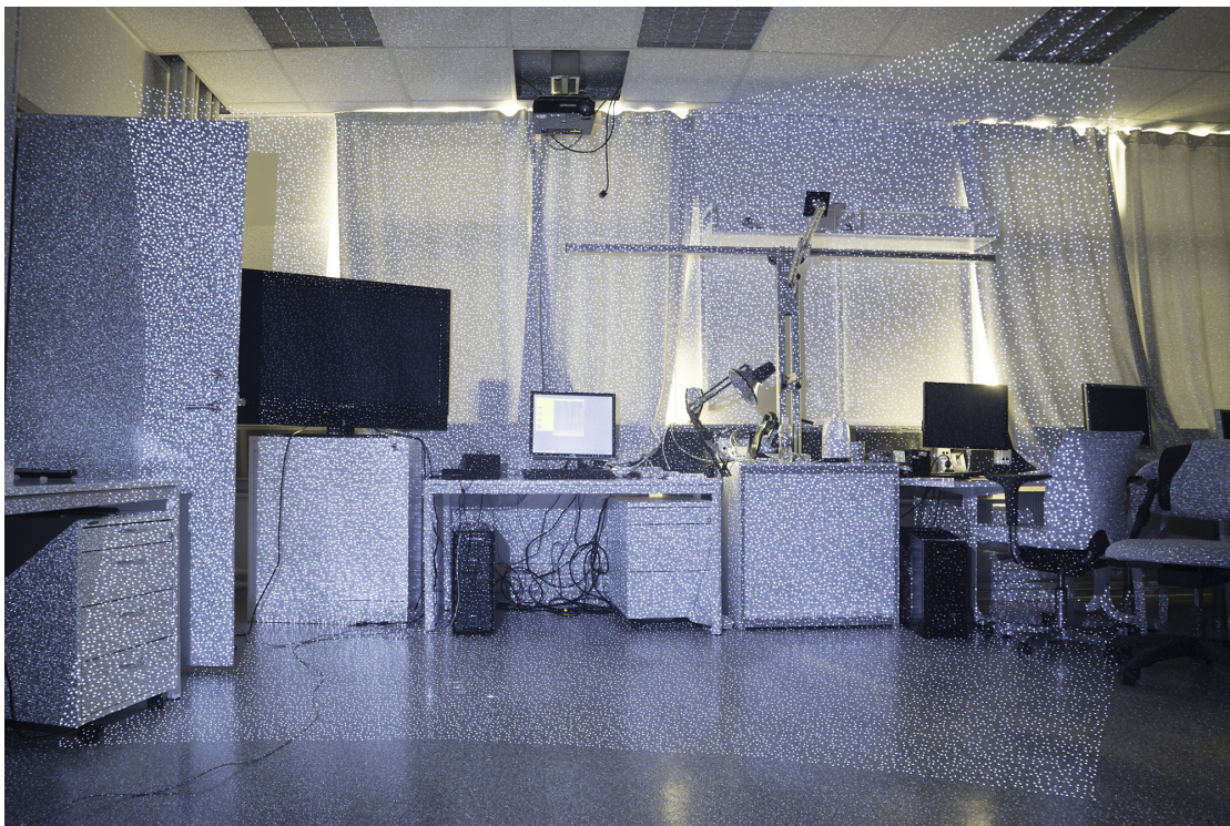
Figur 21: Laboppsett - infrarødt lys med Kinect aktivert og taklys slukket. Rutenettet til Kinect er nå tydelig synlig som et rektangel med putefortegning. Trykk på bilde for link til animasjon som viser overgangen mellom figurene.
