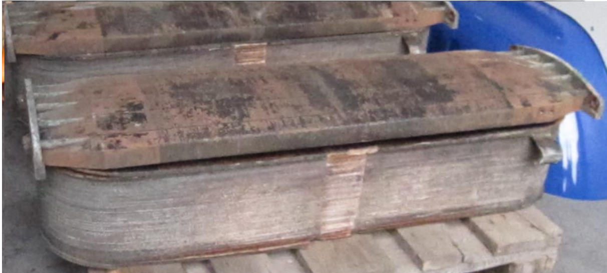
Figur 2.2: To godt brukte poler fra Liafoss kraftstasjon. Disse er rammeviklet. Foto: FAC arkiv.
