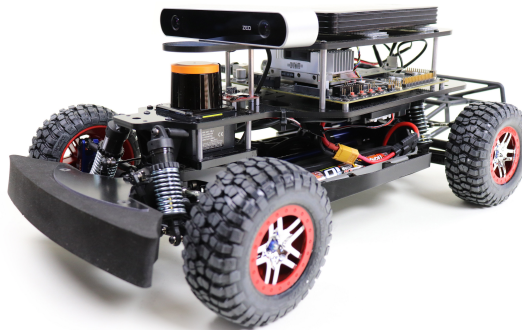
Figure 3.2: MIT RACECAR / RACECAR/J. Ill.: JetsonHacks
