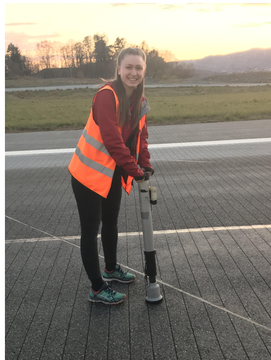
Figur 5: Måling av kjemikaliemengde på rullebane under feltforsøk
