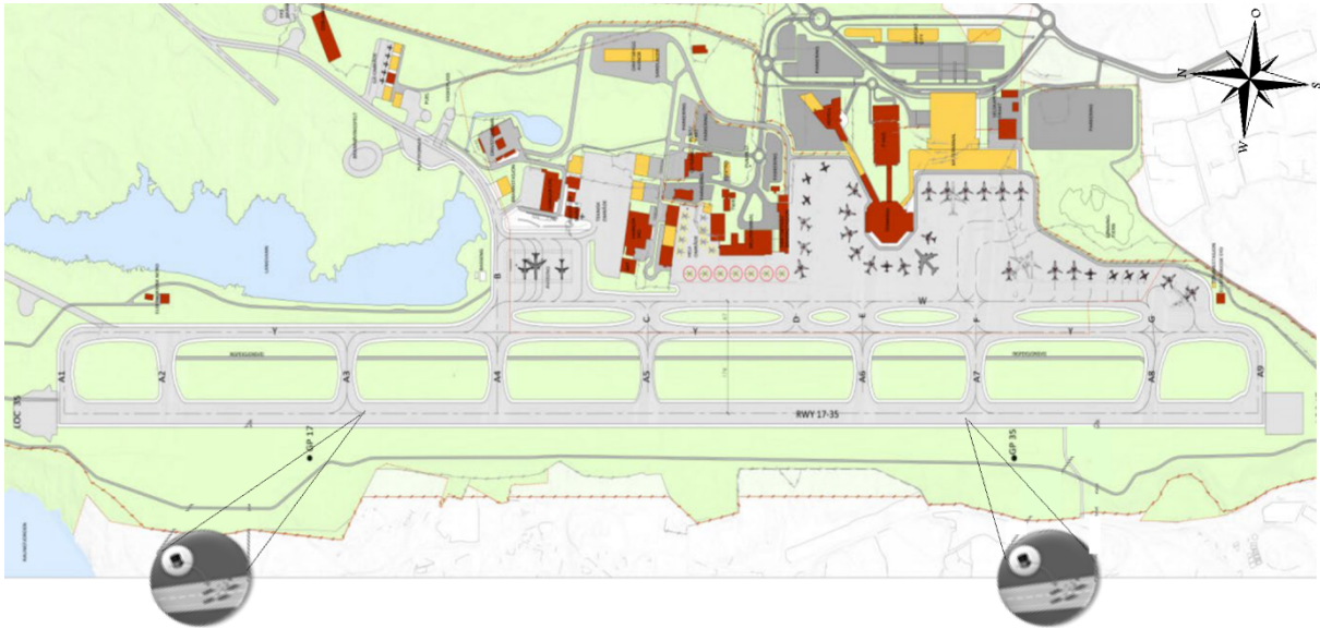
Figur 2: Oversiktsbilde Bergen lufthavn med plassering av sensorer på rullebanen
