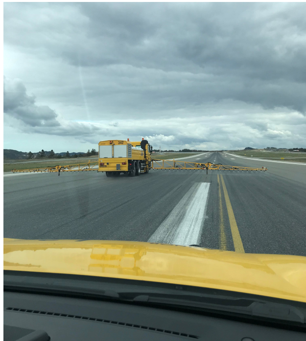
Figur 27: Illustrasjon av dobbelt utlegg under feltforsøk
