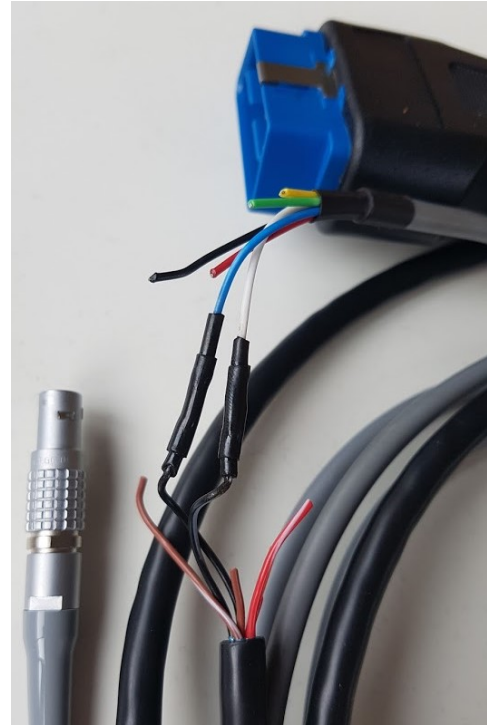
Figur 7.1: Overgang mellom VBOX og OBD type B. (Foto: Andreas Nesdal)
