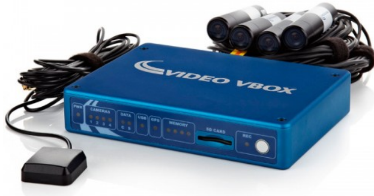
Figur 6.3: Illustrasjon av Video VBOX Pro med tilkoplta utstyr (Racelogic, 2018[b]).
