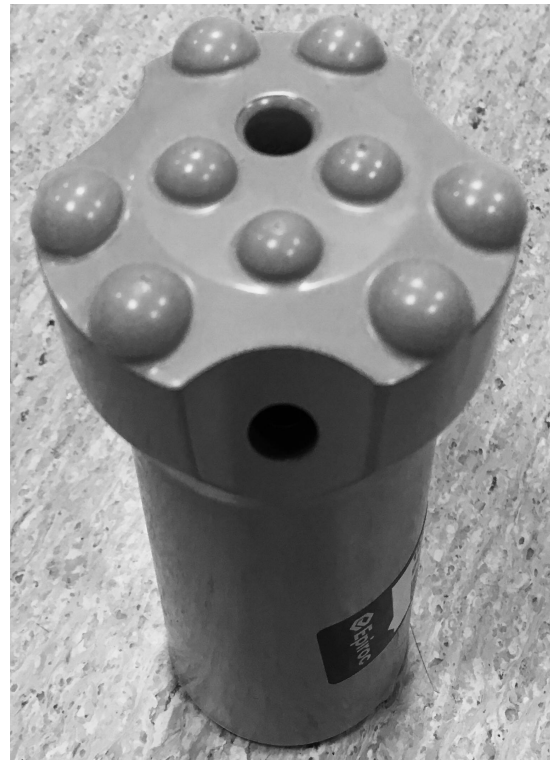
(b) Standard 57mm borkrone totalsondering. Bilde tatt hos Geosafe
