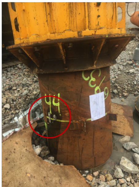
Figur 5.3: Fastmonterte bølgeforplantningsmålere for pel i Åstfjorden. Bilde tatt på befaring.
