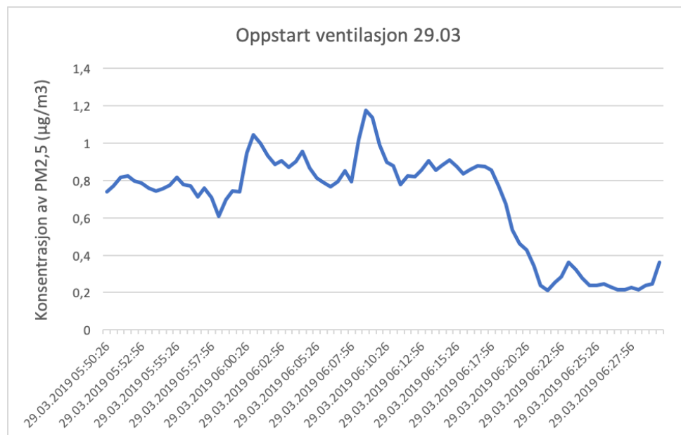
Figur B.4: Utvikling i svevestøvkonsentrasjon i klatrehallen på Dragvoll idrettssenter ved oppstart av ventilasjonsanlegget den 29.03.2019.
