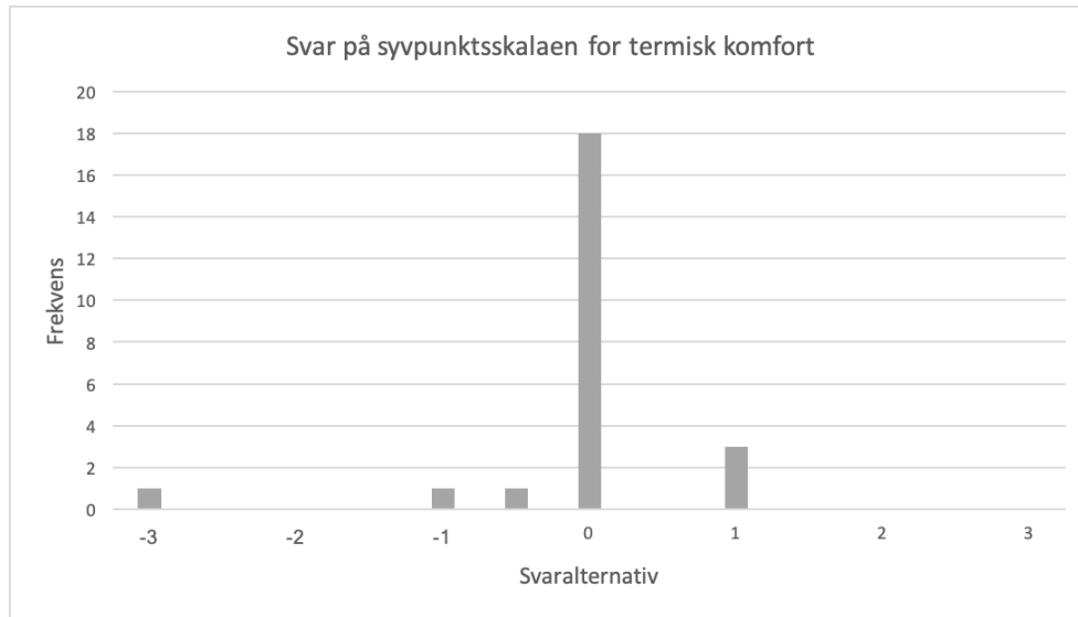
Figur 6.19: Oversikt over besvarelser på spørsmålet "Hvordan oppleves temperaturen i lokalet når du er i aktivitet?" i klatrehallen på Dragvoll idrettssenter. Besvarelser er gitt ved å krysse av på en skala fra -3 (veldig kaldt) til 3 (veldig varmt).
