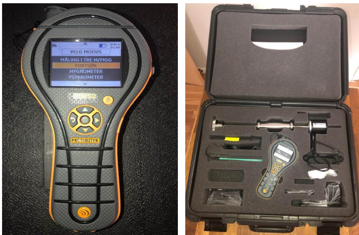
Fig. 1: Fuktmåleinstrument av type protimeter MMS2. Foto: Kanu 2019
