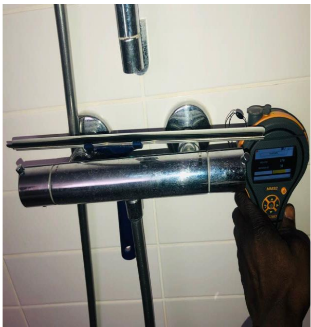
Bilder viser fuktig overflater bak fliser på begge sider av blandebatteri :Varmtvann(vv) og Kaldtvann(kv). Foto: Kanu 2019
