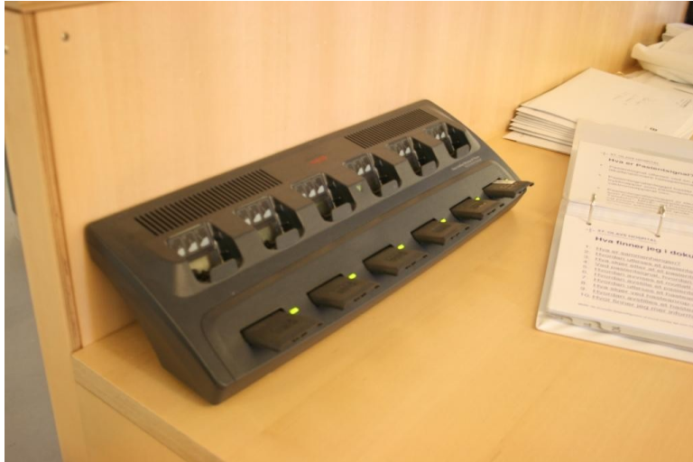
Figur 21: Ladestasjon til trådløs IP-telefon
