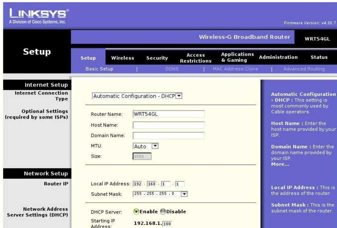
Figur E.1: Linksys WRT54GL oppstartskonsoll
