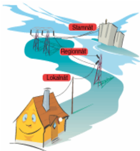
Figur 2. Elnätets beståndsdelar - Bild från Svensk Energi
