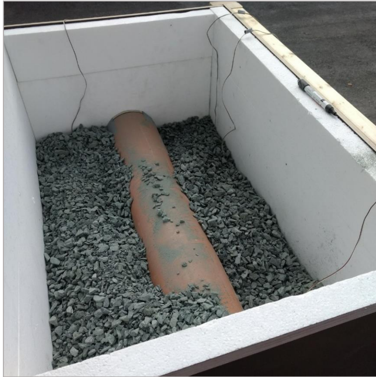
Figur 16. Klargjøring av modellen til forsøk 1. Røret er plassert på riktig dybde og noen termoelementer er allerede plassert og merket.
