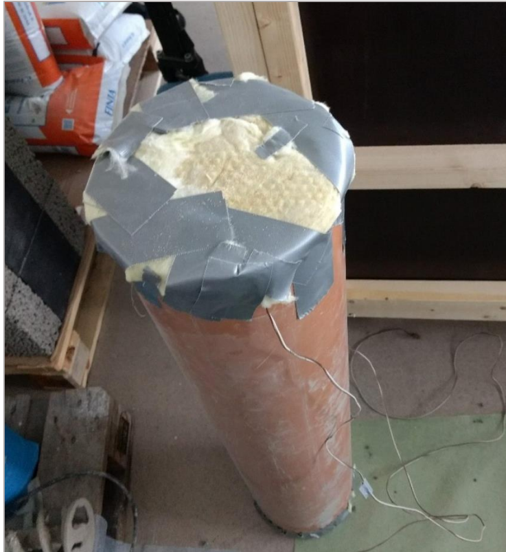
Figur 19. Isolasjon av endestykkene til røret.
