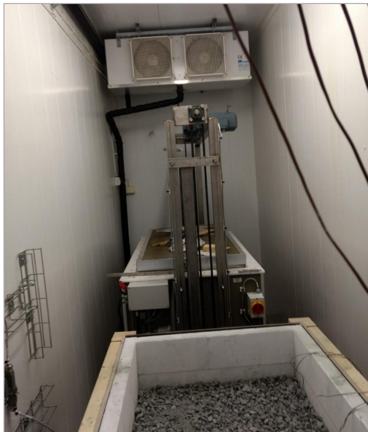
Figur 17. Modellen til forsøk 1 er klargjort og satt inn i fryserommet. Høyt oppe på bildet vises viftene som sørger for temperaturendringene i fryserommet.
