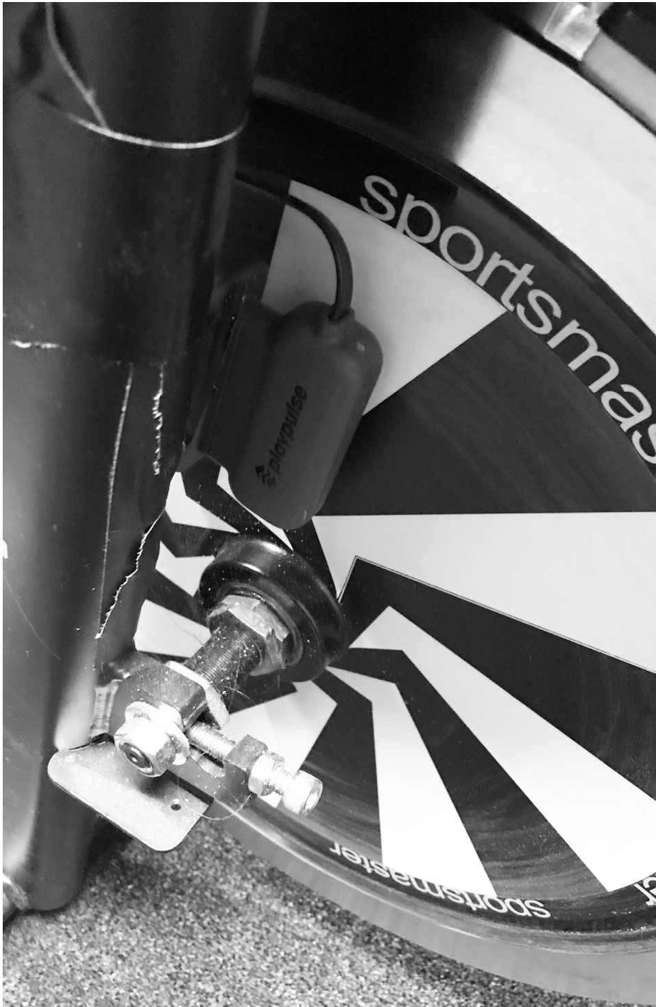
Nåværende fartsmåling skjer via en lyssensor på hjulet
