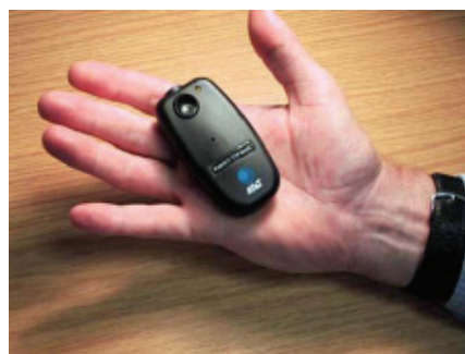
Figur 7: Eksempel på en tag. (Fra Active Bat systemet - AT&T Laboratories Cambridge)
