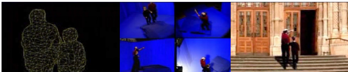
Figur 15-9: Resultatbilder. Mesh kalkulert fra 12 kamera(venstre), multikam(midten), scene(høyre)
