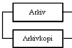
Figur 9-4: Blokkskjema av redundant server A_{\text{parallell}} = 0,9998
