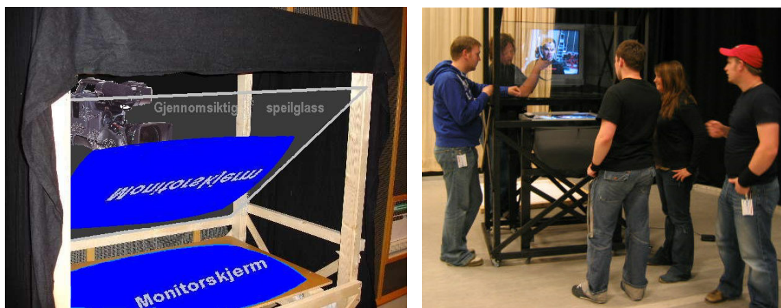
Figur 14-4: Mediatoren. Det halvgjennomskinnelige speilet sørger for blikk-kontakt ved at bildet fra personen man kommuniserer med blir reflektert foran linsen til kamera (Samme prinsipp som i en telepromter).
