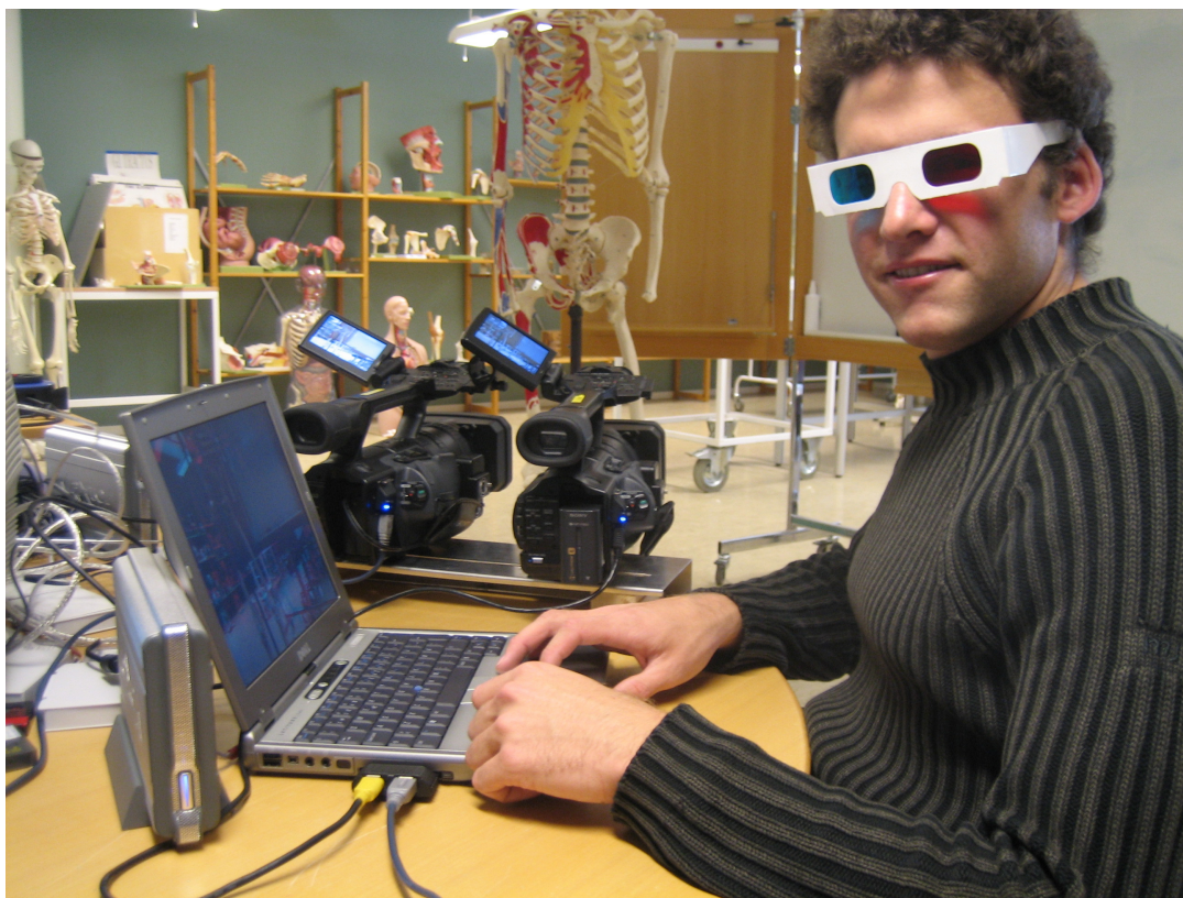
Figur A-13: : Portabelt stereoskopisk visningssystem
