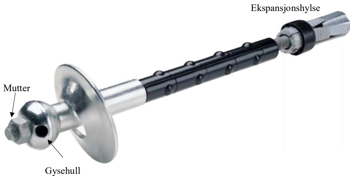
Figur 3.6 CT-bolt er en kombinasjonsbolt som er mye brukt ved sikring av tunneler. Bolten strammes med mutteren til venstre slik at ekspansjonshylsen til høyre festes og bolten spennes opp. Mørtel pumpes inn i gysehullet i kula. Det gjøres oppmerksom på at bolten er en kortere demoversjon. Figuren er basert på DSI Underground (2016).
