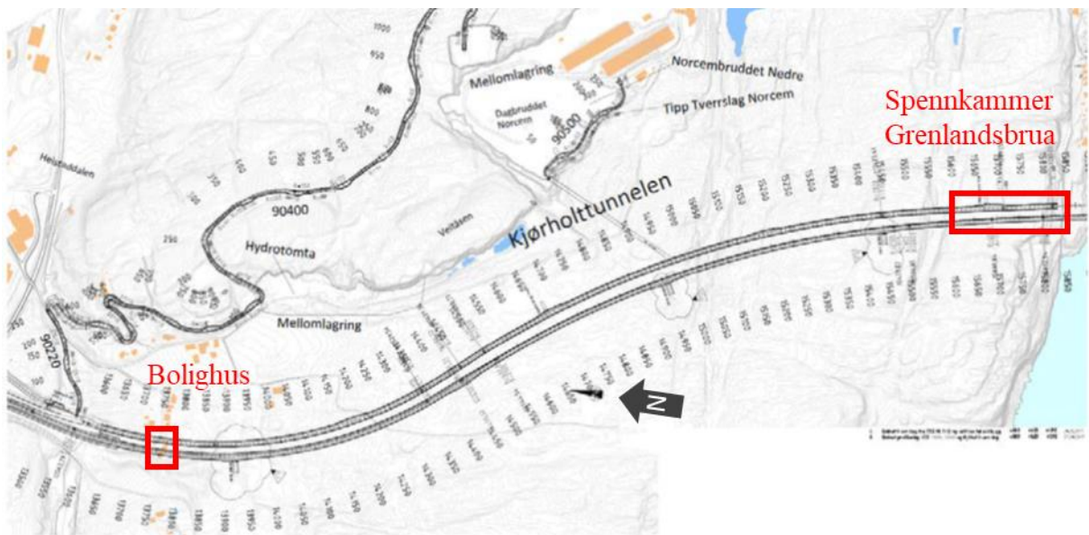
Figur 5.2 Oversiktstegning over Kjørholttunnelen. Områdene med forsiktig sprengning er markert med røde rektangler. Basert på Nye Veier (2018b)
