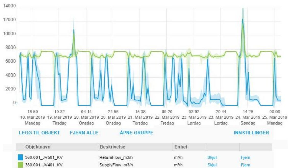
Figur A.3: Leverte luftmengder i Flatåshallen gjennom forsøksperioden uke 12. Grønn graf er tilluft og blå graf er avtrekk. Grunnet kjøring på omluft varierer avtrekksmengden mye. Y-akse viser luftmengde i \text{m}^3/\text{h} .
