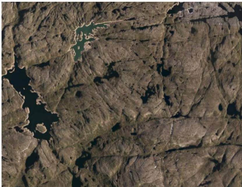
Figur 3.3: Eksempel fra Lysefjord-området på hvordan topografiske lineamenter viser igjen på et flyfoto. Disse indikerer ofte svakhetssoner. Hentet fra nettstedet norgebilder.no .
