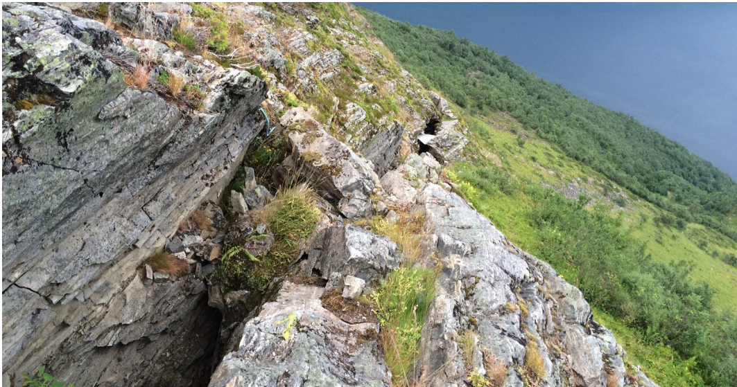
Figur 2.1: Baksprekken strekker seg omtrent 800 meter i N-Ø retning. Foto: L. Kristensen/NVE
