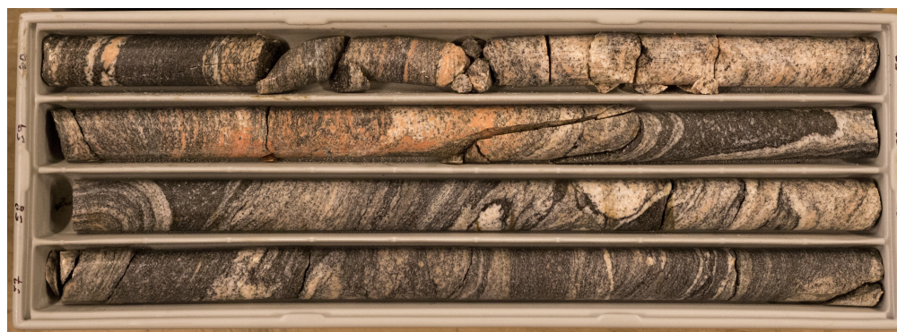
Figur 4.2: Eksempel på hvordan kjernene er plassert i kjernebatter. Hver lengde er én meter lang. Slik logges de meter for meter. Bilde fra NVEs ftp server (NVE, 2019).
