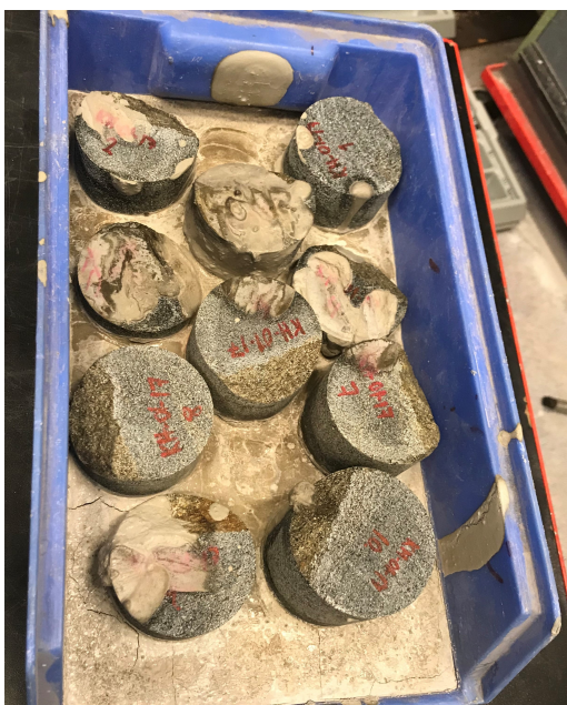
Figur 9.8: Før boring ble kjernene støpt fast.
