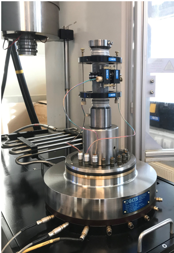
Figur 9.6: Konfigurasjonen ved enaksial trykktest. Her vises kjernen med monterte tøyningmålinger før den skal bli trykksatt aksielt. Foto: Lise Tønset.
