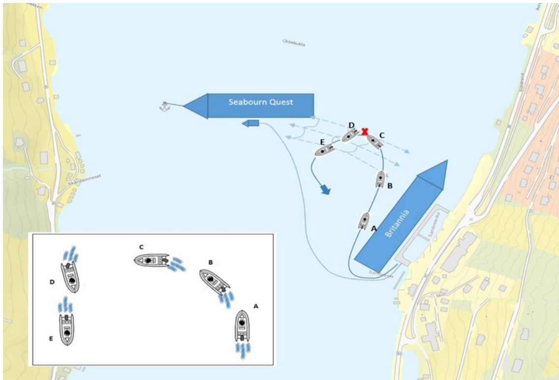
Figur 2.3 – Babord sving der akterenden av fartøyet mister grepet og sladder (SHT 2017).
