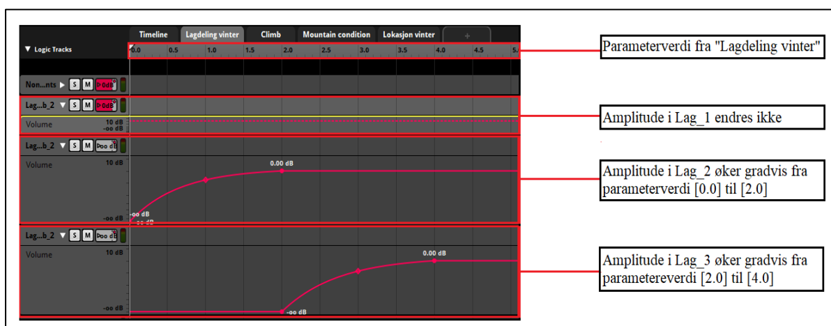
Figur 30 Lagenes amplitudeverdi i respons til parameterverdien fra parameteren Lagdeling vinter .
